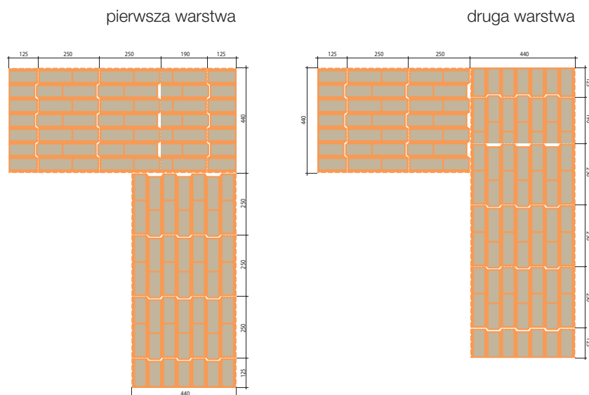
połączenie Porotherm 44 T Profi / Dryfix w narożniku
